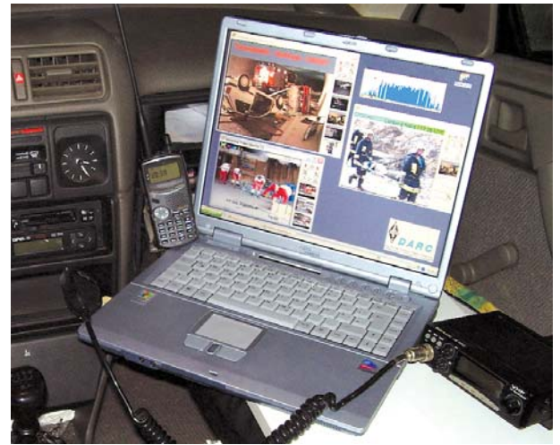
SSTV-Funkstation mobil im Auto betrieben mit Bildern der Notfallübung
